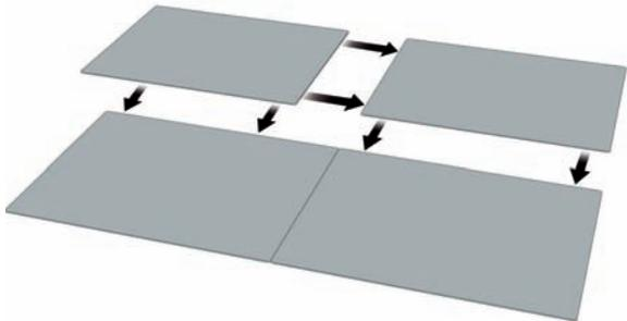
Die Grubenbahnlokomotiven enthalten Magnete. Durch die Metallplatten (unter den Schienen) wird der Anpressdruck der Loks erhöht. Dadurch wird die Stromaufnahme verbessert und eine ruckelfreie Fahrt ermöglicht.
