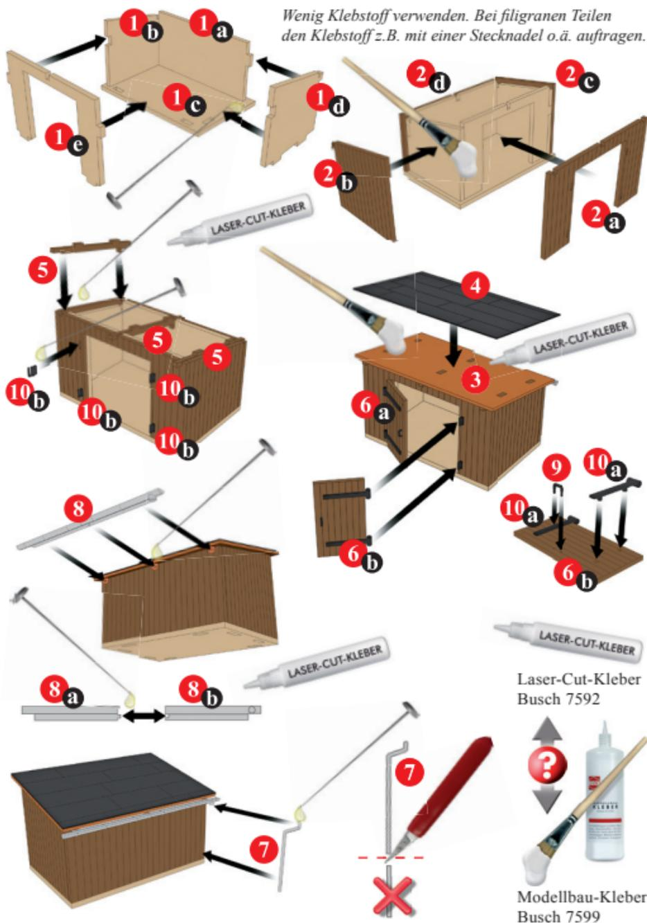
Wenig Klebstoff verwenden. Bei filigranen Teilen den Klebstoff z.B. mit einer Stecknadel o.ä. auftragen.
