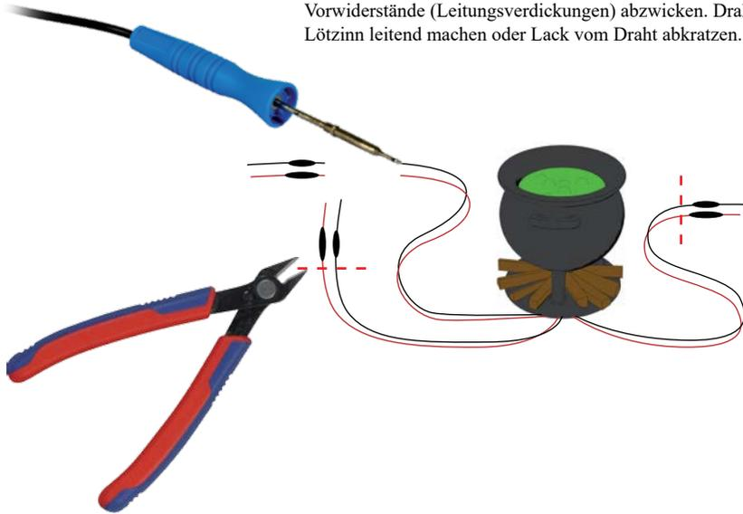
Vorwiderstände (Leitungsverdickungen) abwickeln. Drahtenden mit Lötzinn leitend machen oder Lack vom Draht abkratzen.
