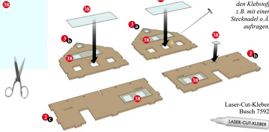
Wenig Klebstoff verwenden. Bei filigranen Teilen den Klebstoff z.B. mit einer Stecknadel o. Ä. auftragen.
