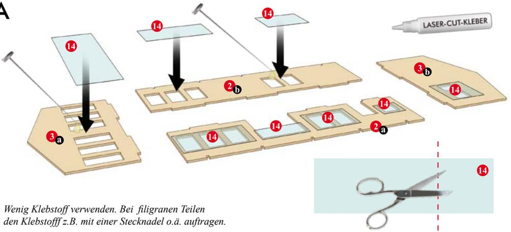
Wenig Klebstoff verwenden. Bei filigranen Teilen den Klebstoff z.B. mit einer Stecknadel o.ä. auftragen.
