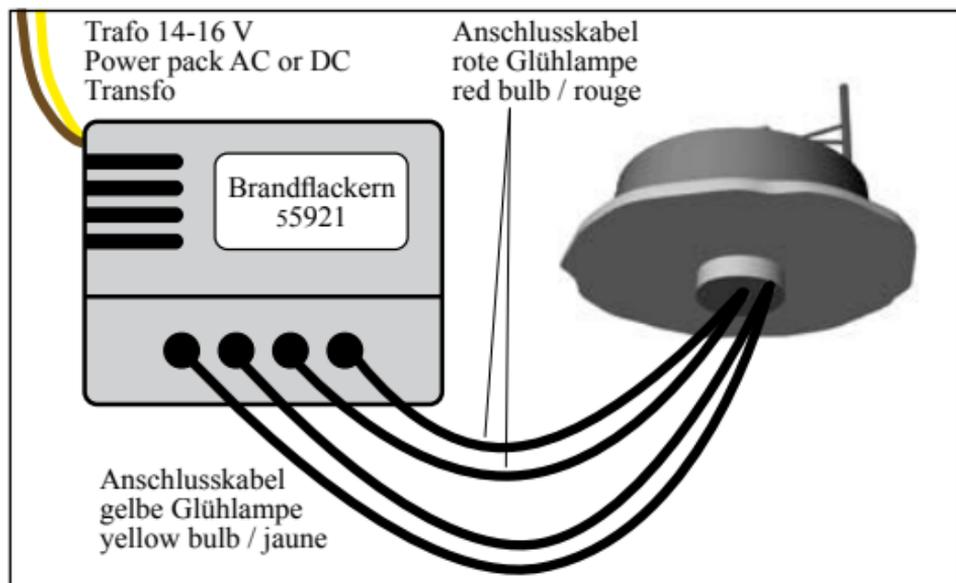
Da sich beim Dauerbetrieb Wärme entwickelt, sollte die Schaltung nicht in einem luftdichten Gehäuse eingebaut werden. Die Möglichkeit einer geringen Luftzirkulation ist zu beachten.
