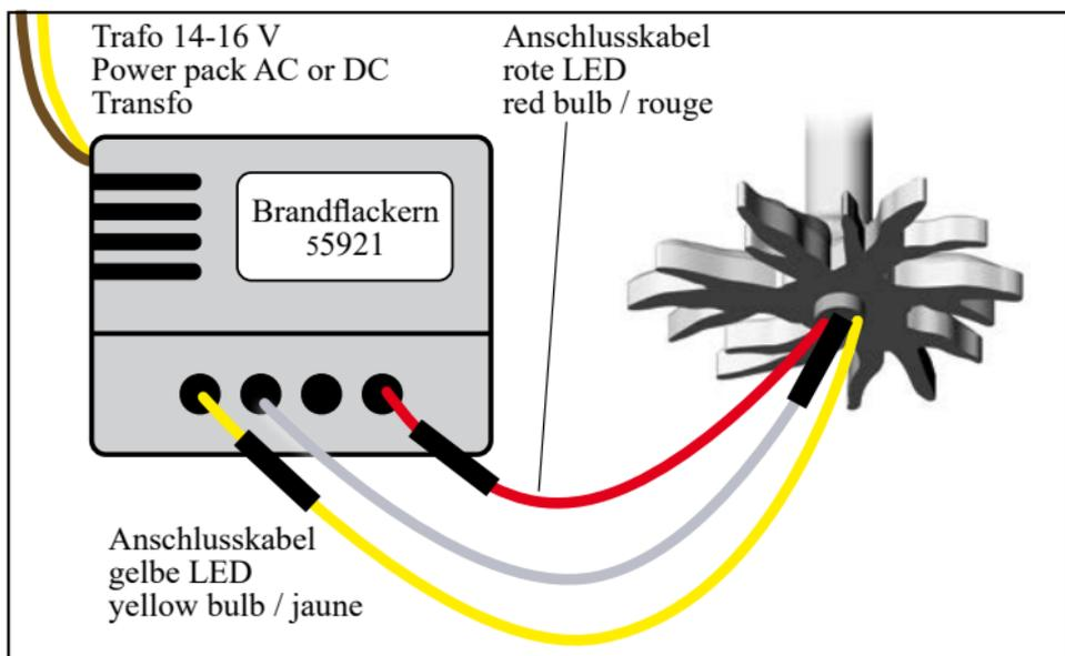
keine Funktion ergibt, sind die Anschlusskabel am Trafo umzupolen. Da sich beim Dauerbetrieb Wärme entwickelt, sollte die Schaltung nicht in einem luftdichten Gehäuse eingebaut werden. Die Möglichkeit einer geringen Luftzirkulation ist zu beachten. Für die Montage auf der Modellbahnplatte wird ein Loch von ca.  $\varnothing$  0,7 cm benötigt. Das Packungsbild zeigt einen Gestaltungsvorschlag.
