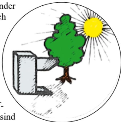
IR-Empfänger möglichst so aufstellen, dass Fremdlicht nicht von der Senderseite hereinfällt (evtl. einen Baum als Schattenspendler verwenden).
